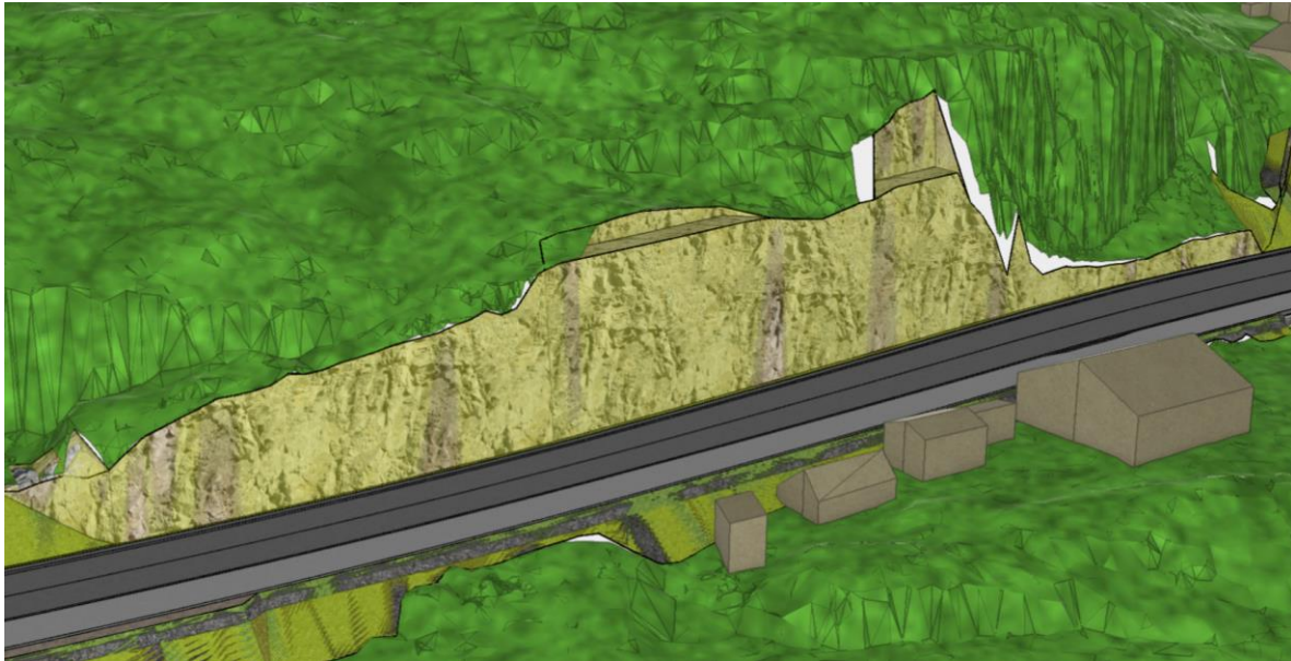
Figur 18: Utsnitt fra vegmodellen i Trimble som viser planlagt utforming av beskjæringen og planlagt veglinje. I tillegg viser modellen terrengoverflaten og eksisterende bygninger.
