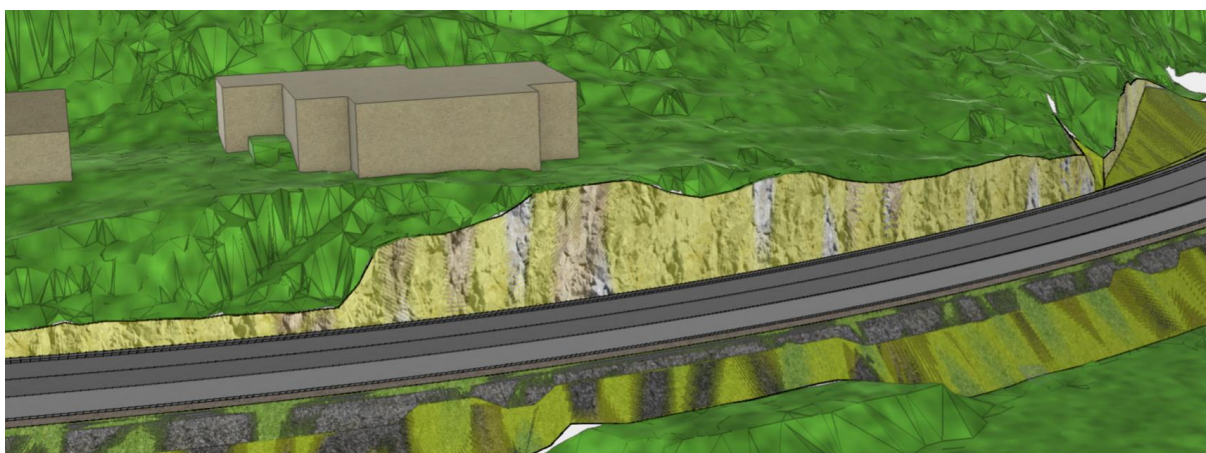
Figur 15: Utsnitt fra vegmodellen i Trimble som viser planlagt utforming av beskjæringen og planlagt veglinje. I tillegg viser modellen terrengoverflaten og eksisterende bygninger.
