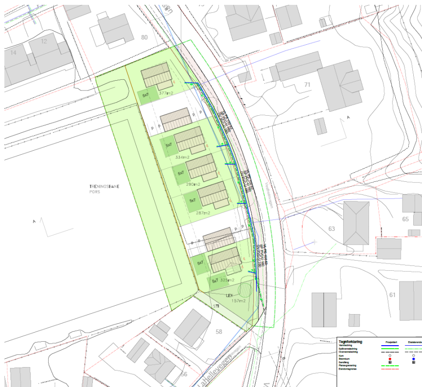
Figur 37, Overordnet plan for eksisterende og prosjekterte ledninger i området, VA rammeplan, Sweco AS, vedlegg 16 i planbeskrivelsen
