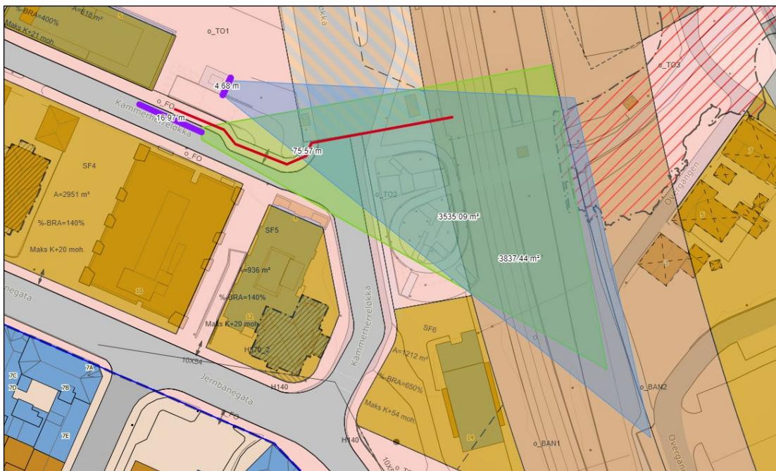
Figur 28: Figuren viser siktforholdene mellom midtpartiet av jernbanepattform og bussoppstillingsplasser for "buss for tog"-løsning.
