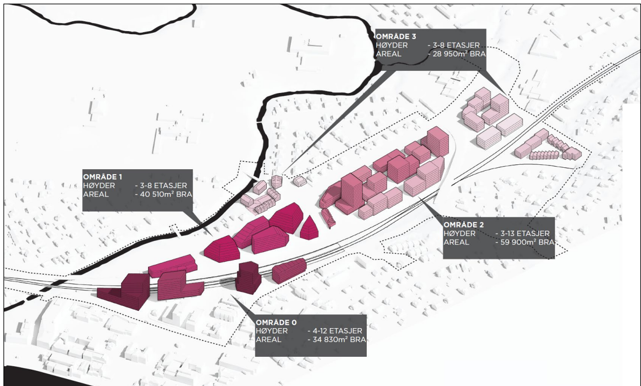
Figur 14: Illustrasjon som viser tenkt etasjehøyder og utnyttelse for tenkt bebyggelse innenfor planområdet. Illustrasjon av Add Arkitekter. Oppdatert etter 1. gangsbehandling og høring.
