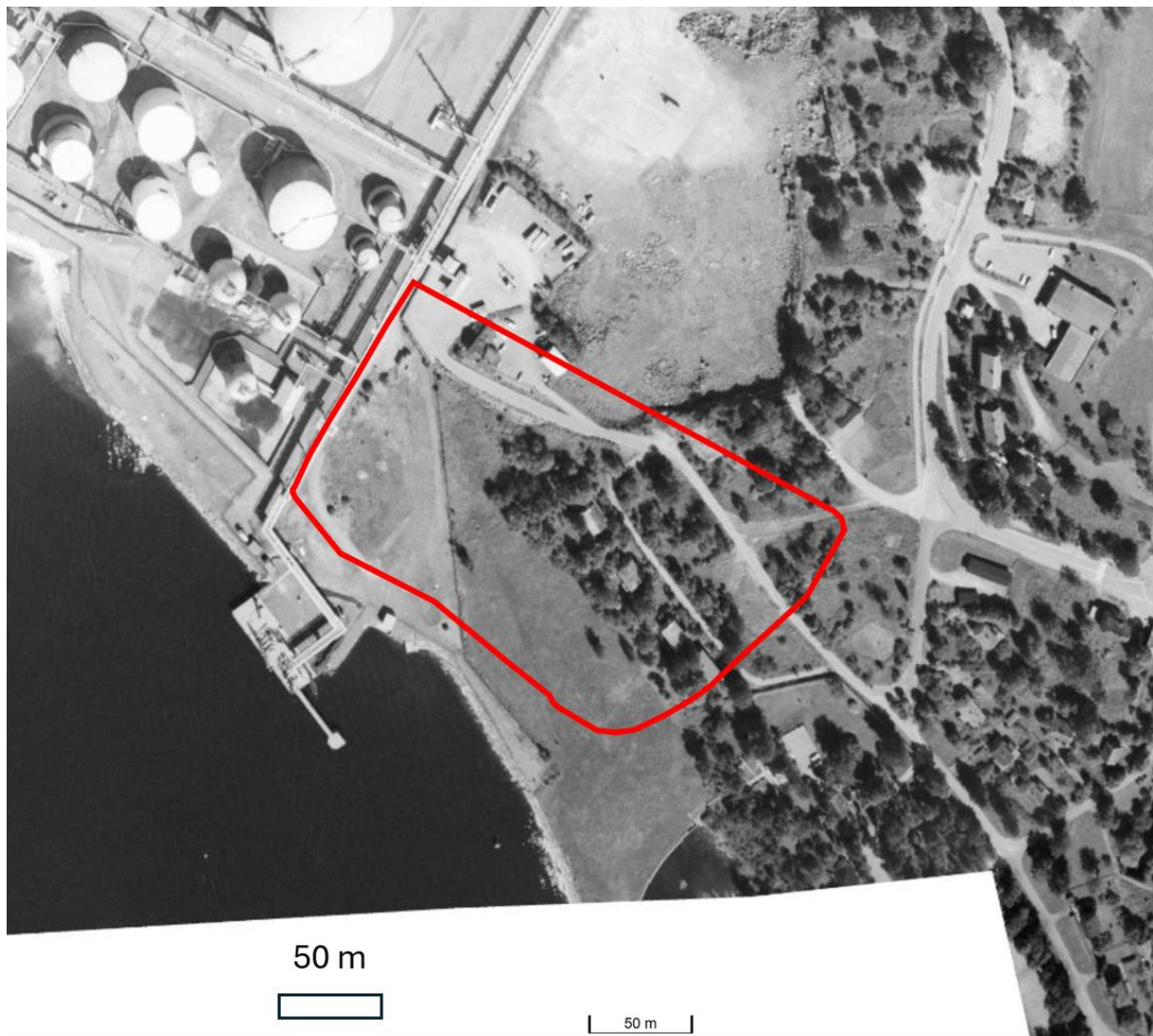
Figur 9: Flyfoto av eiendommen fra 1991. Sjøarealet ble fylt ut med ukjente, og mest sannsynlig forurensede masser, tilsvarende dagens tilstand. De utfylte arealene er nivellert, uten noen aktiviteter. Nord for undersøkelsesområdet er arealet også nivellert, her ble det i senere år en pukkverkvirksomhet etablert. Tankanlegget til vinylkloridproduksjon vises mot vest fra undersøkelsesområdet. Kai 1 som ble bygd etter utfyllingen, er tilkoblet til ulike virksomheter med rørledninger bygd på søyler.
