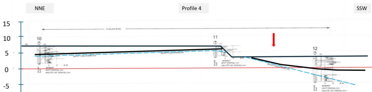
Figur 35: Det gjengitte tverrsnittet 4 (traseen er angitt i Figur 31) fra 2007 fra den geotekniske rapporten [11], med loggede totalsonderinger i borehull, og med AFRYs tolkning av formasjonsgrensene. Den stiplede lyseblå linjen er toppen av berggrunnen, den svarte linjen er toppen av marin siltig leire, og den grå linjen representerer terrengoverflaten. Det øverste laget mellom den grå og den svarte linjen er forurenset fyllmasse. Den tidligere strandlinjens posisjon i tverrsnittet er vist med en rød pil. Den vertikale skalaen er meter under og over havnivå. Havnivået er angitt med en rød linje.
