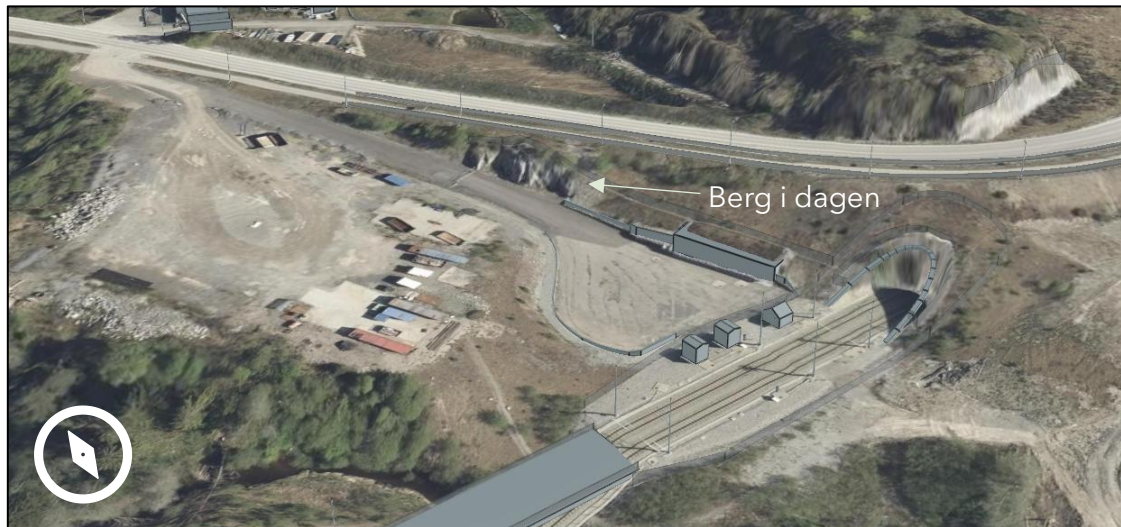
Figur 3-1: 3D-kart som viser berg i dagen på deler av planområdet. Kilde: 3d.kommunekart.com.
