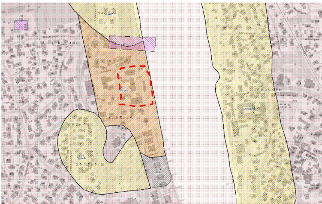
Figur 20 Utsnitt av NVE atlas med kartlagte kvikkleiresoner https://atlas.nve.no .
