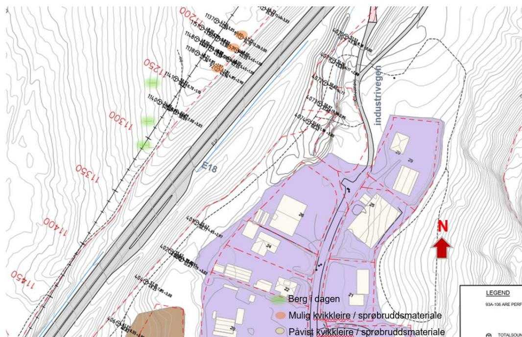
Figur 5-3 Grunnforhold Rød profil 11200 - 11450
