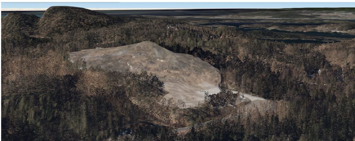
Figur 23: 3D illustrasjon, oversiktsbilde sett fra øst som viser avslutningsfase med oppfylling og nytt terreng, uten vegetasjon. Det formede terrenget har god og naturlig overgang mot bevart terreng som gjør at det kan bli en naturlig del av landskapet i ettertida. Det forutsettes at området blir revegetert etter oppdaterte prinsipper for naturrestaurering slik at området til slutt vil bidra til naturmiljøet.
