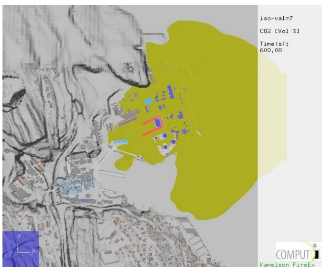
Figur 9-7: Ved flytting av tankene og vegger rundt disse når utslipp av 500 kg CO 2 i sekundet med svak vind (1 m/s) fra nord ikke boliger og småbåthavn i sør. Skyen viser en CO 2 -konsentrasjon på 70 000 ppm. Hentet fra risikoanalysen 70/
