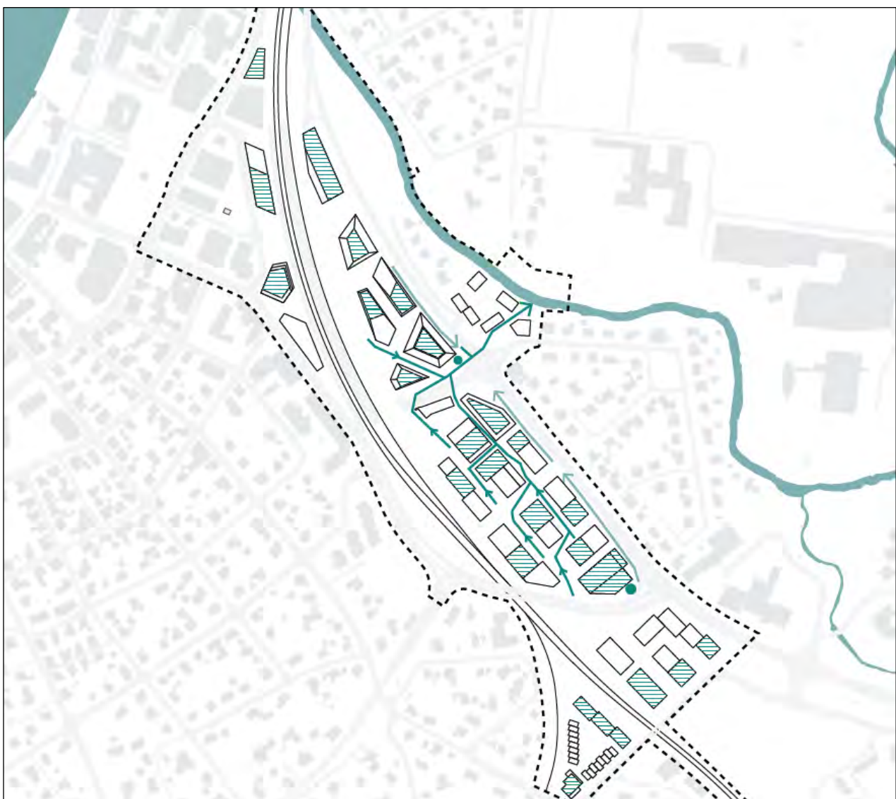
Figur 29: Overvannsdiagram viser prinsipp for overvannshåndtering, plangrensen er vist i stort stiplede linje.
