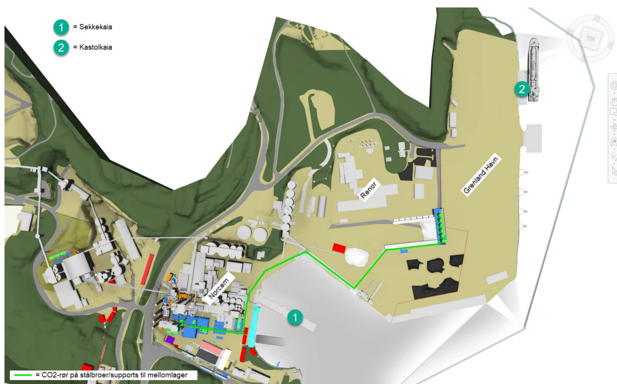
Figur 3 Rørføringsalternativ til mellomlager
