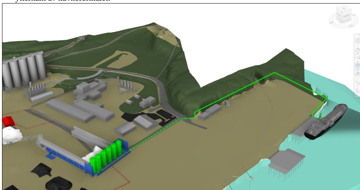
Figur 25: Viser alternativ 2 ro-ro/lo-lo nord hvor stiptet grønn strek viser CO 2 rør i kulvert, og heltrukket grønn strek viser CO 2 rør på stålbroer/supports.
