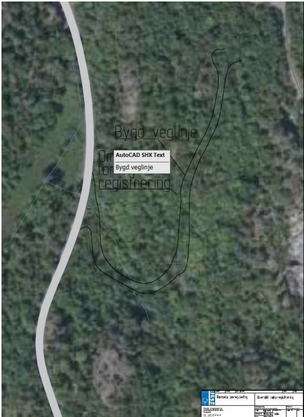
Figur 6. Trase for anleggsveg basert på ortofoto.
