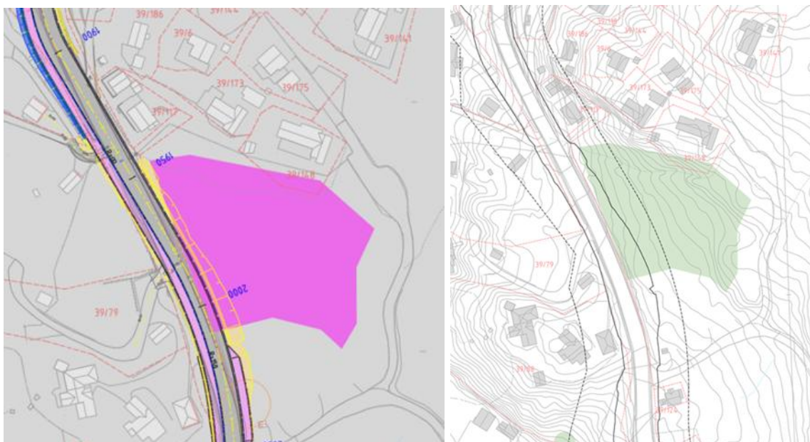
Figur 5-3. Massefyllinger og skjæringer vises i gult, naturtypelokaliteten i lilla (t.v.) og hele anleggsbelte (stiplet linje) iht. naturtypelokaliteten i grønn (t.h.).
