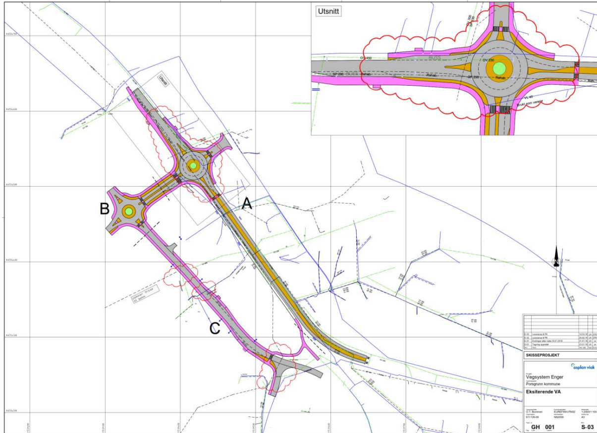
Figur 5. Omlegging av kommunalt ledningsanlegg som følge av veganlegget
