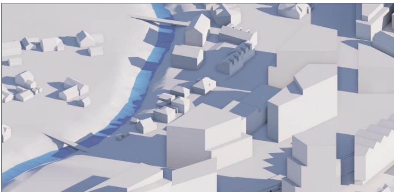
Figur 5-42: Solforhold av alternativ i SF8 med maks kotehøyde +22 langs fv.32 mot boligområde B1, vår- og høstjevndøgn, 21. mars og 21. september kl. 15.00. Kilde: 3D-modell av alternativt forslag SF8, Dyrvik arkitekter.
