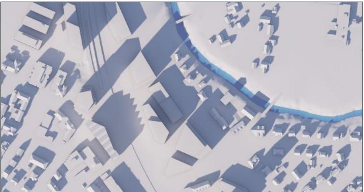
Figur 5-44: Solforhold av alternativ i SF8 med maks kotehøyde +22 langs fv.32 mot boligområde B1, vår- og høstjevndøgn, 21. mars og 21. september kl. 15.00. Kilde: 3D-modell av alternativt forslag SF8, Dyrvik arkitekter.
