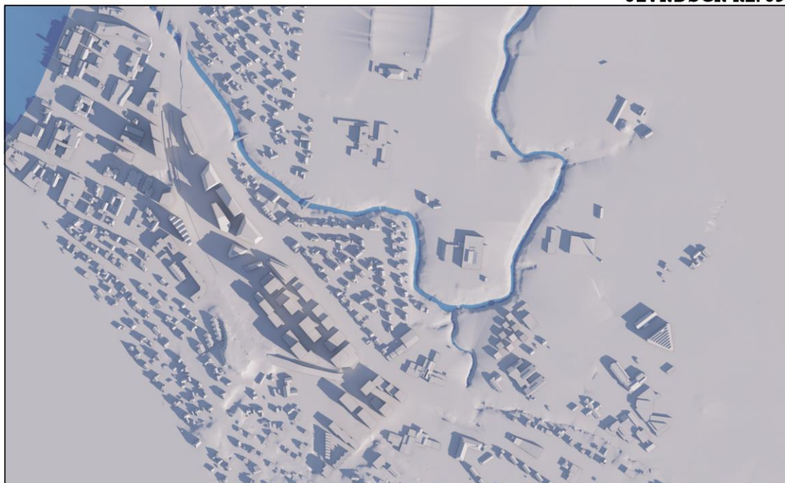
Figur 5-28: Vår- og høstjevndøgn, 21. mars og 21. september kl. 09.00. Kilde: 3D-modell av planforslaget, Dyrvik arkitekter.
