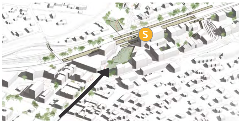
Jernbanegata forlenges under spor og fv.32
