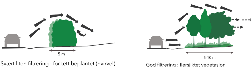
Figur 5-3: Prinsipper for oppbygging av vegetasjonsfelt.
