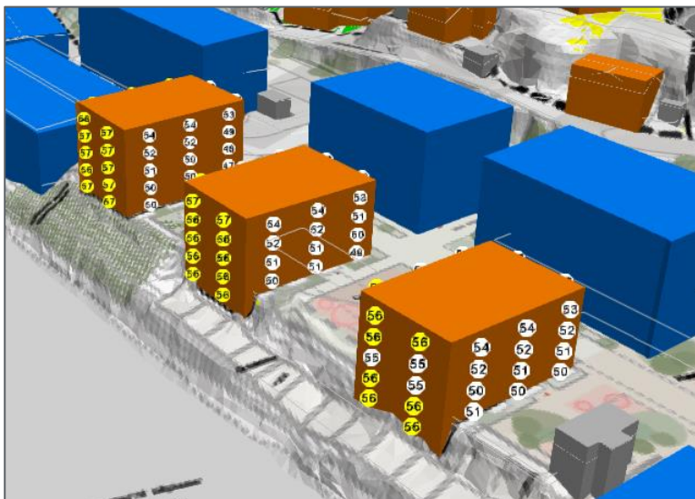
Figur 16 Sumstøy BKT. Fasadenivåer Lden vist.
