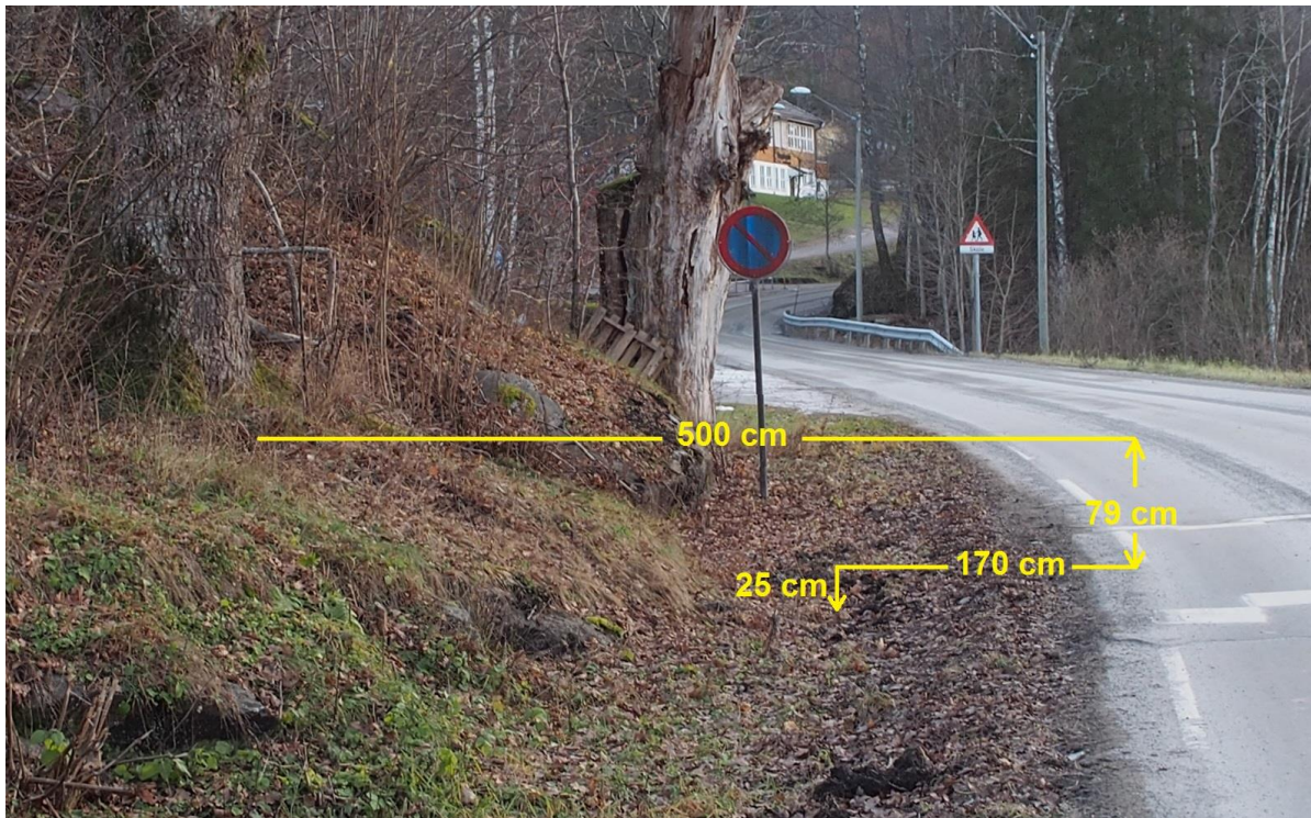
Figur 10. Den levende eika står 500 cm fra hvit stripe og basis ligger 104 cm over hvit stripe. Største dybde på grøfta er 25 cm målt 170 cm fra hvit stripe. Foto: forf.
