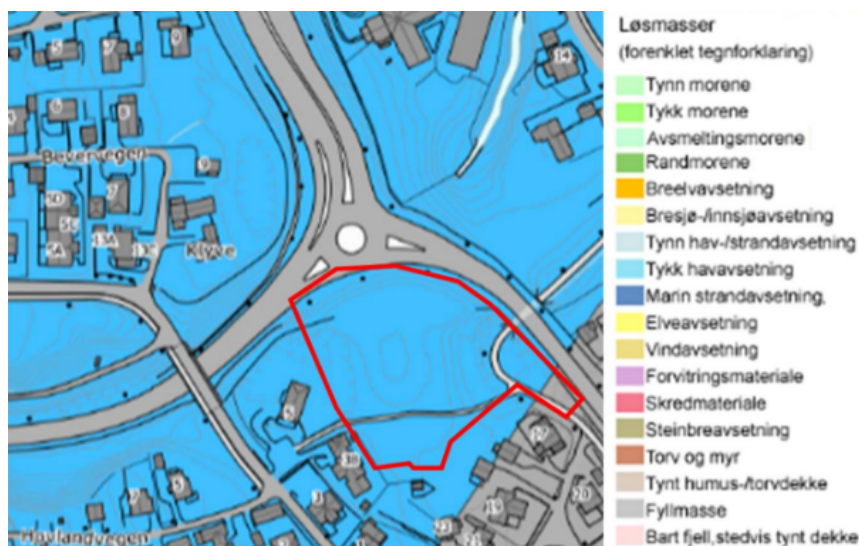
Figur 6 Utsnitt fra kvartærgeologisk kart viser forventet løsmasse i øvre lag.
