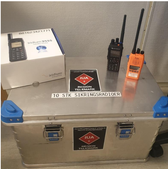
Satellittelefon, nødnett og skogsikringsradio er eksempler på alternativt samband ved bortfall av mobilnett
