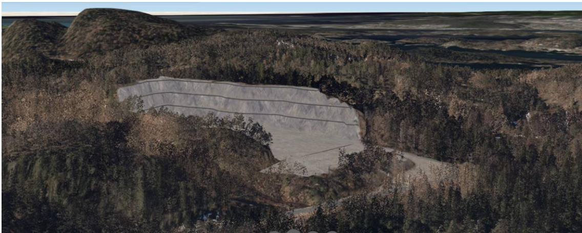
Figur 7 Bildet viser 3. etappe i bruddet. I denne situasjonen er man kommet så langt ned i bruddet at det er blitt en sammenhengende flate med driftsområdet.
