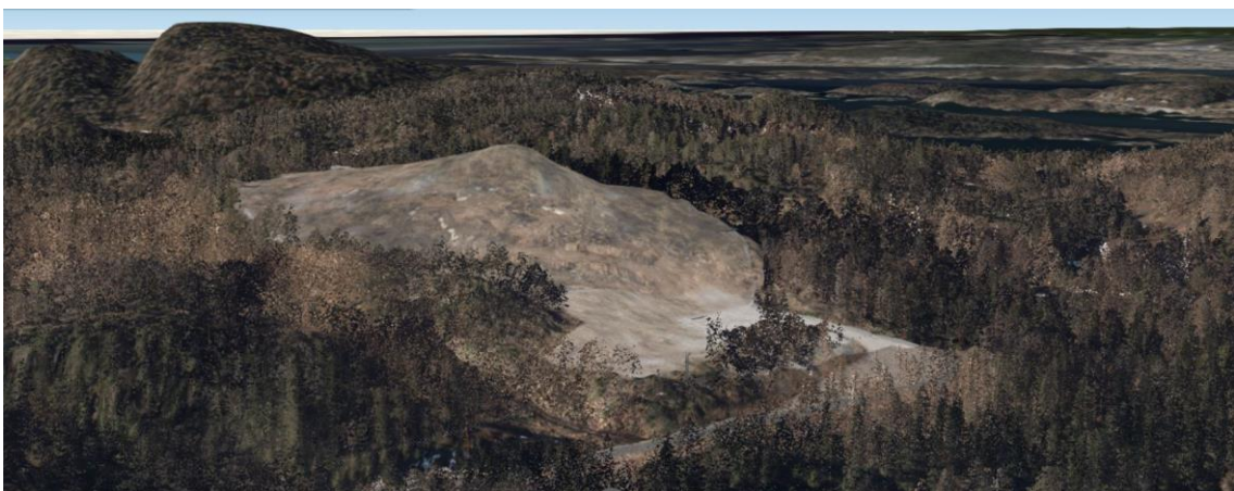
Figur 8 Bildet viser avslutningsfase der terrenget er formet slik at det er en god tilslutning til omkringliggende terreng. Det legges opp til revegetering med stedegne toppmasser og naturlig innvandring i avslutningen av prosjektet.
