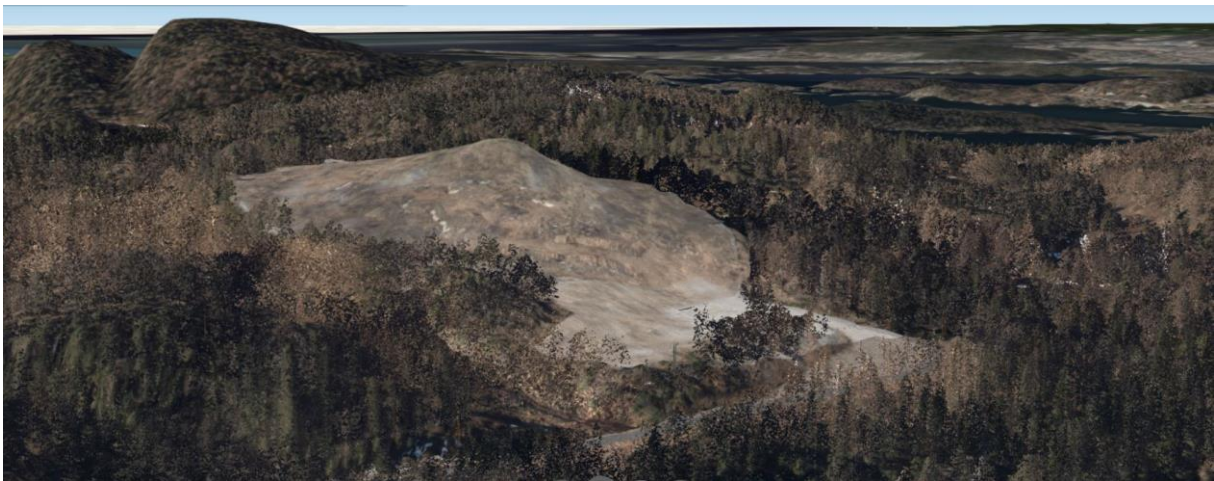
Figur 23: 3D illustrasjon, oversiktsbilde sett fra øst som viser avslutningsfase med oppfylling og nytt terreng, uten vegetasjon. Det formede terrenget har god og naturlig overgang mot bevart terreng som gjør at det kan bli en naturlig del av landskapet i ettertida. Det forutsettes at området blir revegetert etter oppdaterte prinsipper for naturrestaurering slik at området til slutt vil bidra til naturmiljøet.
