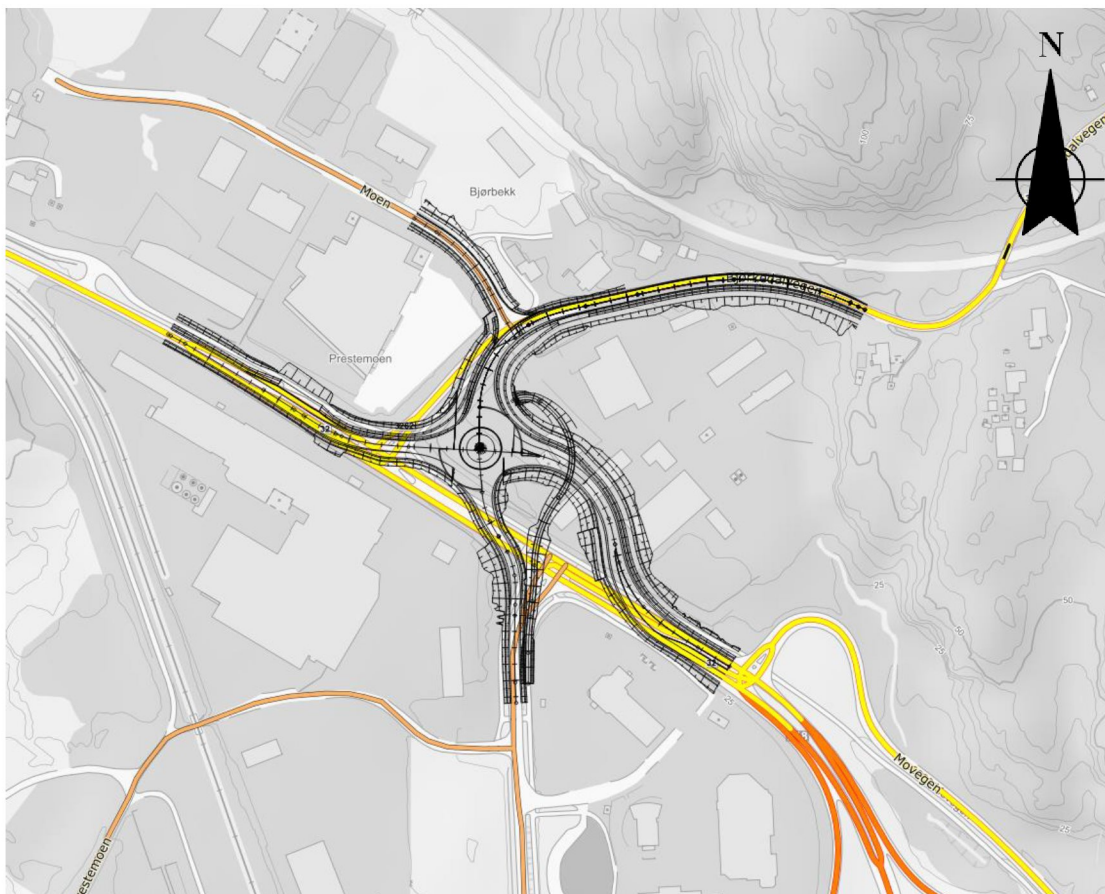
Figur 1: Oversikt over eksisterende RV32 og planlagt ny rundkjøring. Kart generert i QGIS.
