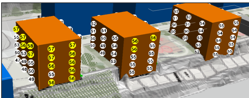
Figur 14 Sumstøy BKT. Fasadenivåer Lden vist.
