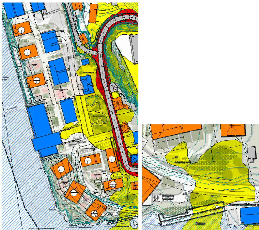
Figur 5 Støysonekart, L_{den} , fremtidig situasjon, veitrafikkstøy . Høyde 1,5 meter. Sum veier (venstre) og støy fra Breviksveien/-bro alene (høyre)
