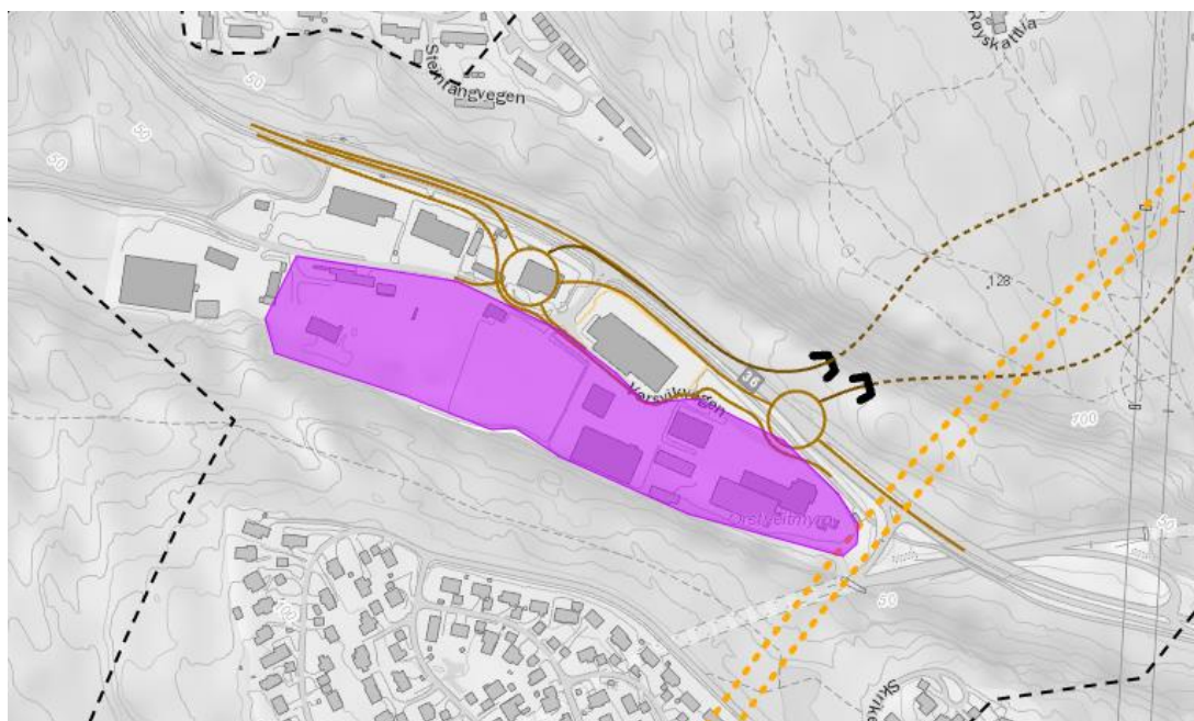
Figur 5-27 Utsnitt av GIS-portal som viser veg-trase gjennom Skjelsviksdalen. E18 går i tunnel under Skjelsviksdalen (oransje stiplet linje), mens adkomstvei med to rundkjøringer og tilknytning til rv. 36 ligger i dagen (brun). Antatt avgrensning av deponiet er skissert med lilla areal.
