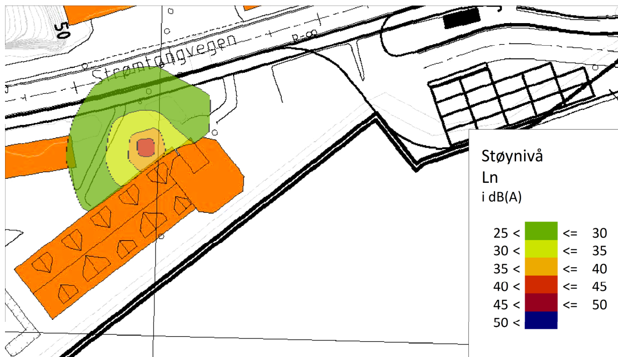
Figur 2 - Støy fra kun trafo. A-veid tidsmidlet lydnivå ( L_{pA,T} ). Beregningshøyde 4 m over terreng.
