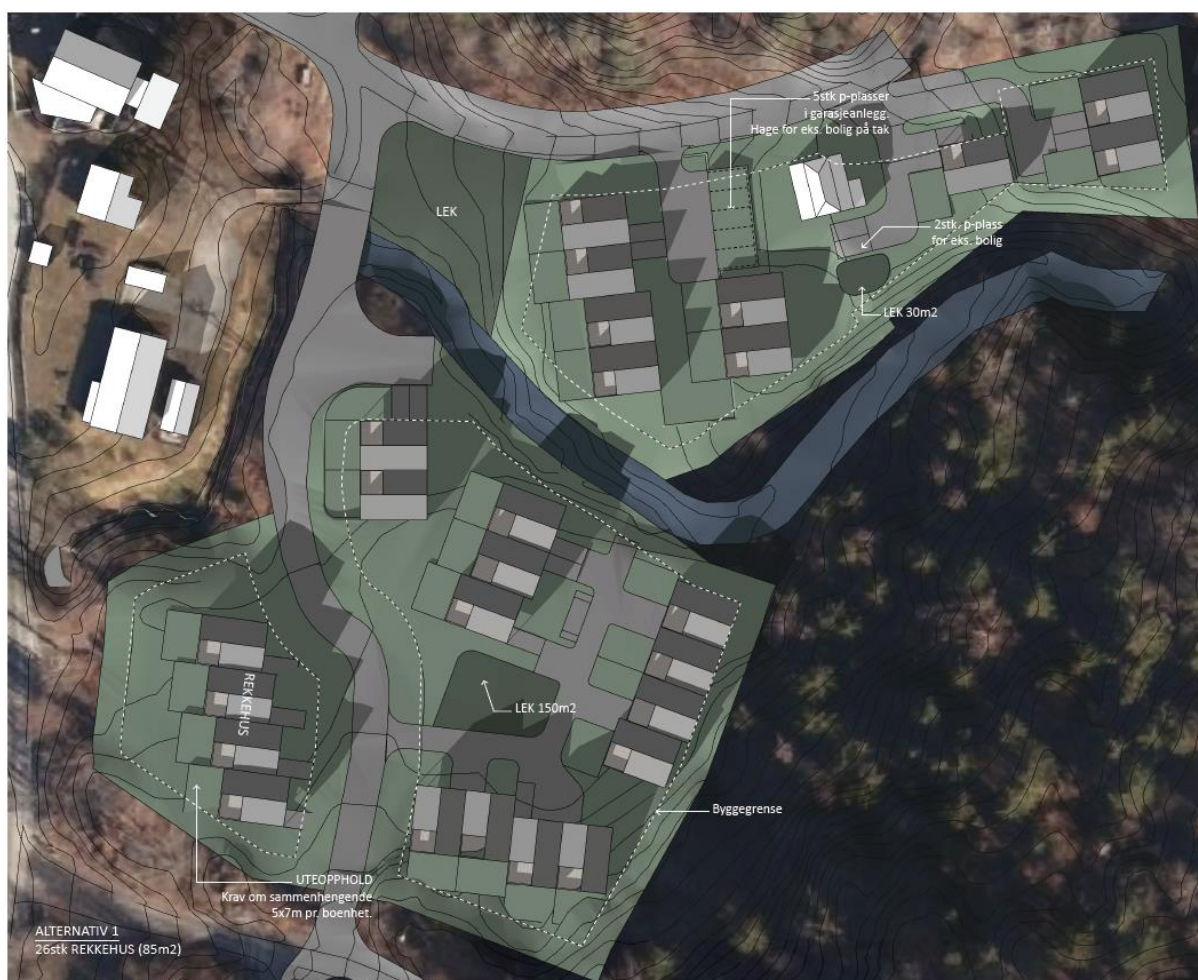
Figur 4: illustrasjonsplan som viser mulig utbygging innenfor reguleringsplanens rammer. Planen viser sol/skygge-forhold kl. 15:00 den 21. mars. Illustrasjonen viser at uteområdene har gode solforhold.
