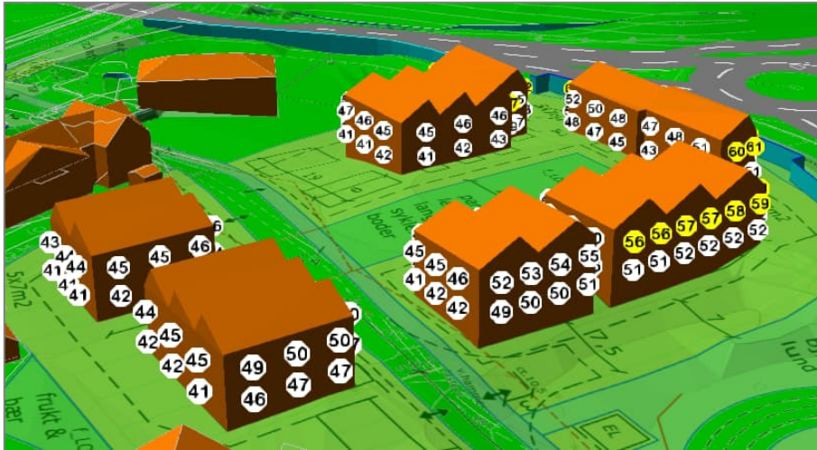
Figur 6: 3D-view. Lydnivå L_{den} på fasader, sett fra nordvest og sørøst. Fremskrevne trafikktall for 2033 er benyttet.
