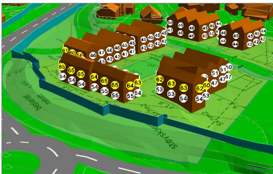
Figur 5: Lydnivå L_{den} på fasader. Høyeste nivå uavhengig av etasje er vist. Skjermet alternativ med ny støyskjerm i blått, høyde 2,4 m over terreng. Ny skjerm kobles på eksisterende støyskjerm i cyan farge. Fremskrevne trafikktall for 2033 er benyttet.
