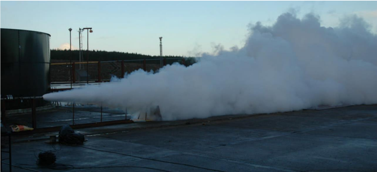
Figur 5: Eksempel på stor lekkasje av CO 2 . Gasskyen kan ofte sees som en tåke, pga vannet i luften som kondenserer som følge av lav temperatur. Bildet er hentet fra CO2PIPETRANS [6].
