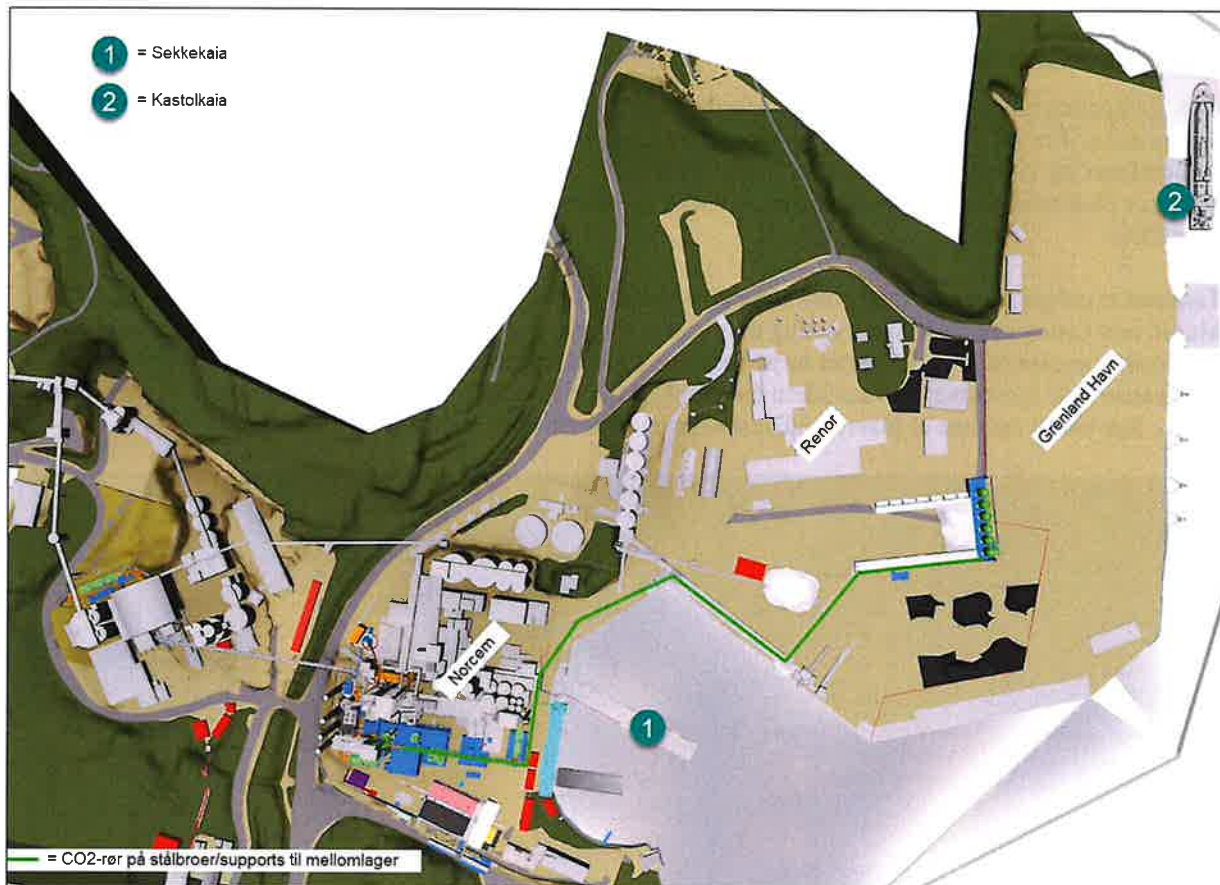
Figur 23: Viser plassering av de to alternativene til plassering og rørføringer for utskipning av CO 2 .
