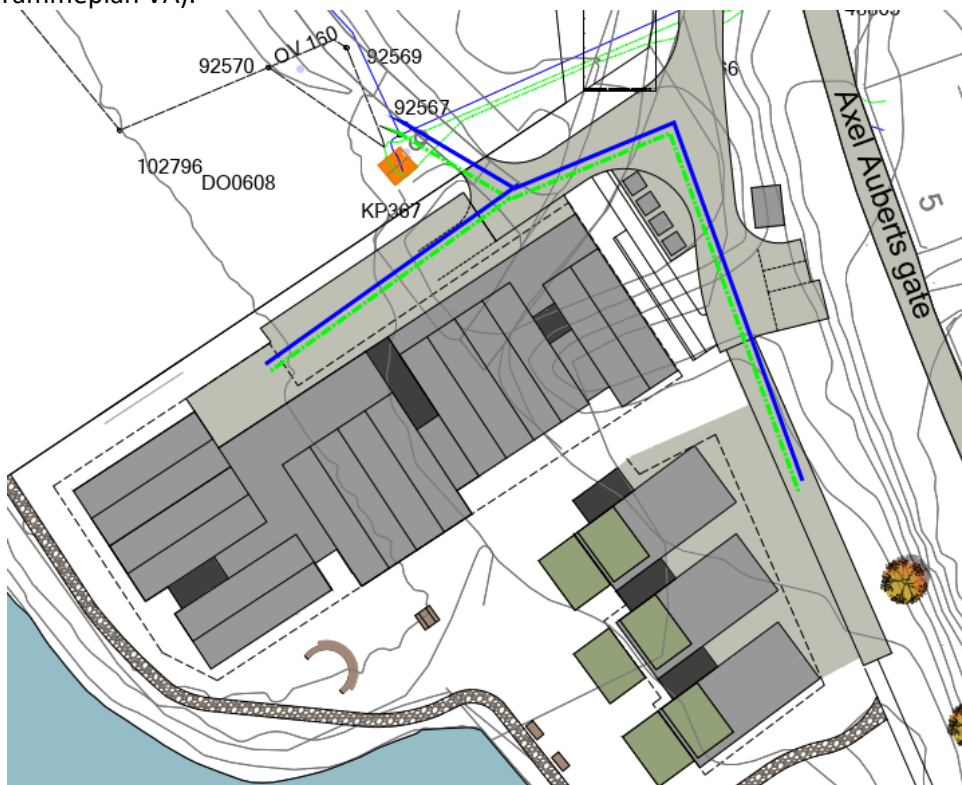
Figur 36: Foreslått trasé for vann og spillvann.
