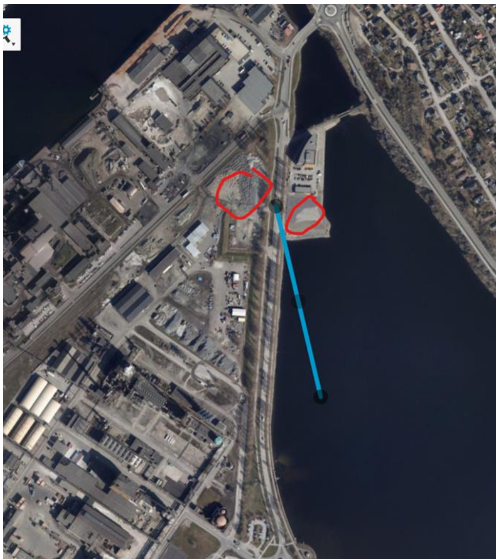
Figur 4. Deponilokasjon Gunnekleiv. Dei raude sirklane syner areal for mellomlagring av massar, medan den blå lina syner retning for tipp/masseutfylling.
