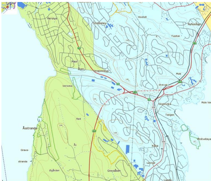
Figur 5-12. Berggrunnsgeologi over planområdet som viser kalkstein, leirskifer, mergelstein (lys blå farge) og leirskifer, sandstein og kalkstein (grønn farge) (ngu.no).
