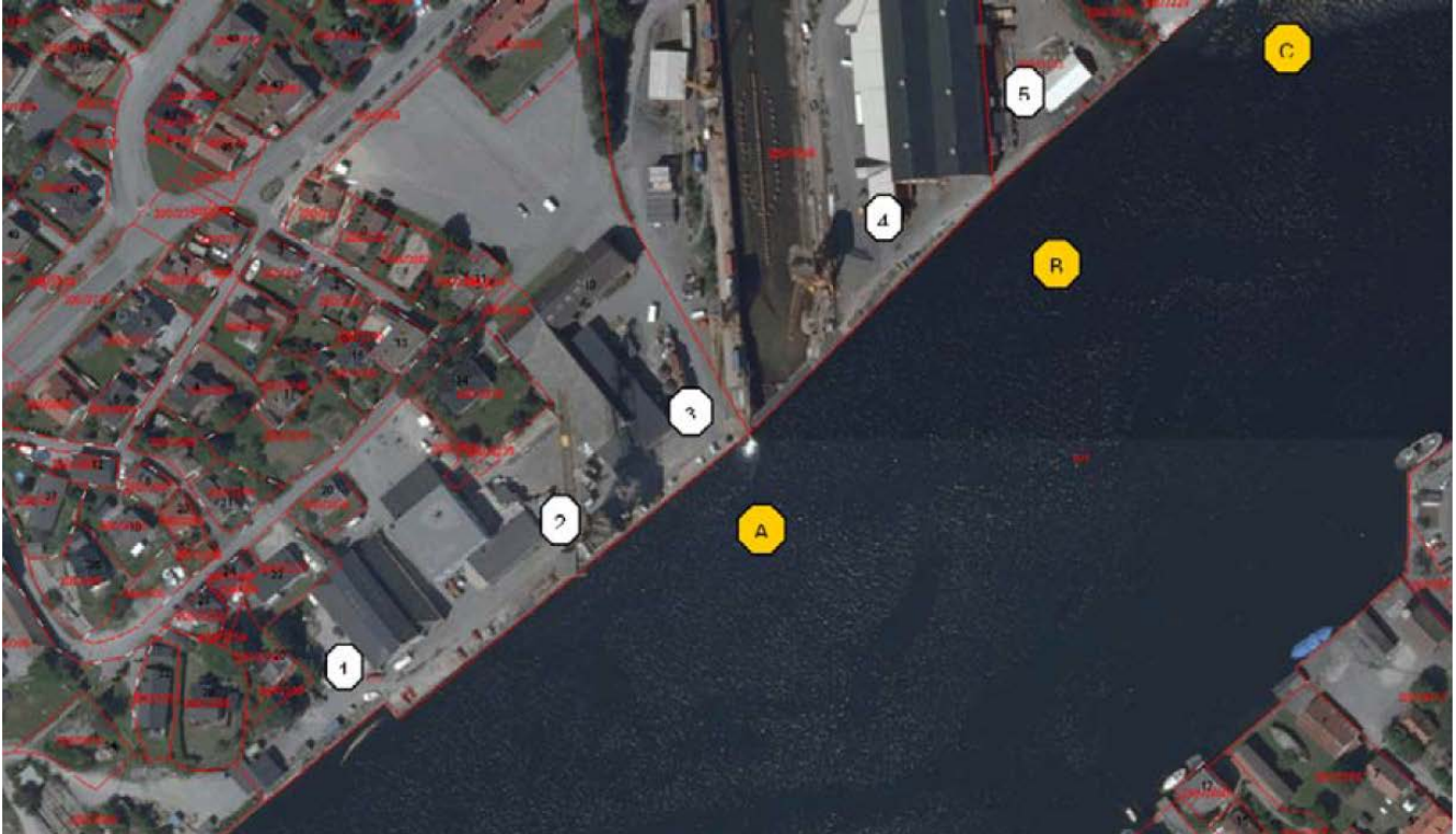
Figur 1: Prøvetakingsplan med prøvepunkter på land og i elven. Gule punkter er sedimentprøver (A, B, C). Hvite punkter er jordprøver (1-5). AF Decom 2009.
