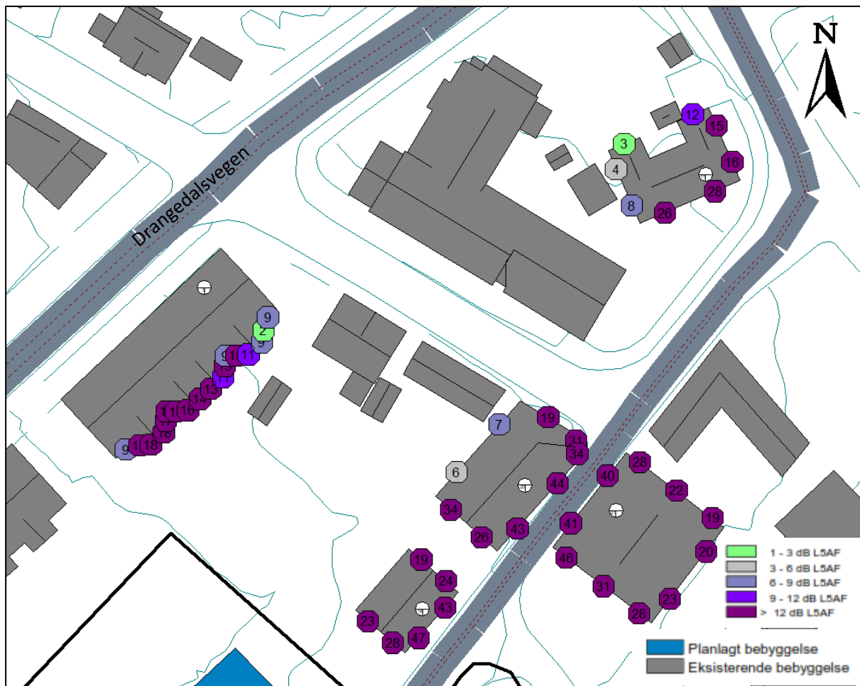
Figur 4-10: Figuren viser differanse i støynivå L_{5AF} for høyeste fasadenivå differanse mellom alternativ 1 og nullalternativet for boliger som må vurderes for støytiltak. Vurderingsgrunnlaget for støytiltak er basert på det maksimale støynivået i nattperioden, dvs. L_{5AF} .
