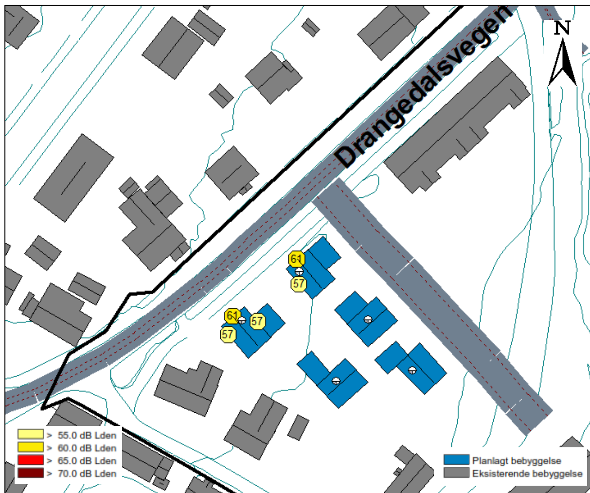
Figur 4-2: Figuren viser høyeste fasadenivåer L den for de planlagte boligene i vest for alternativ 1.
