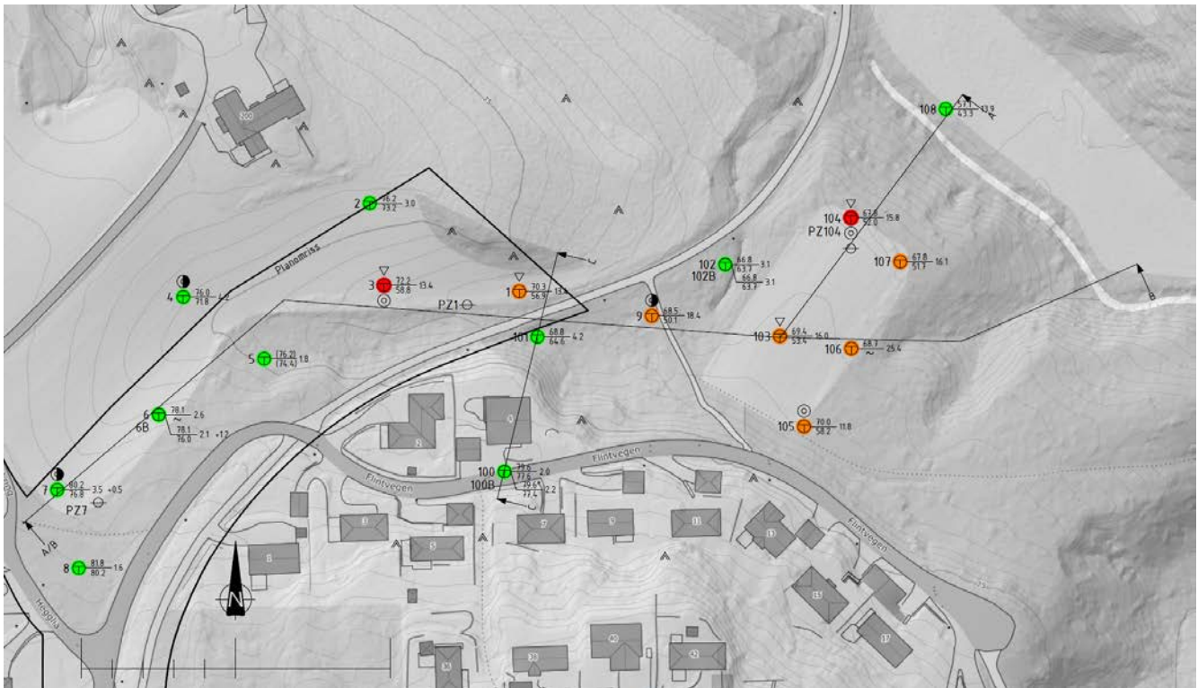
Figur 13 Utsnitt fra tegning 115540-1 med tolkning av sprøbruddmateriale påtegnet borplan.
