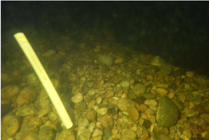
Figur 24: Urspolat material återfunnet på botten.
