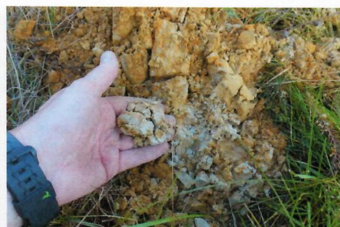
Bilde 3. og 4. Viser stedlige løsmasser av finsand i den øverste delen av undergrunnen.
