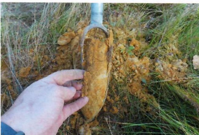
Bilde 3. og 4. Viser stedlige løsmasser av finsand i den øverste delen av undergrunnen.
