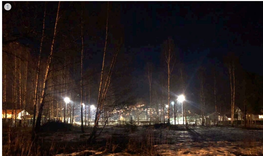
Belysning av treningsbanen mot øst gjøres av flomlyskastere med nøytralhvite 4000K lyskilder som har en fargegjengivelse rundt RA 80. En fokusering av armaturene vil kunne redusere strølys mot tomten. Metallhalogenlyskilder har små brennere og dermed også potesial for å avgi et mer presist lys enn armaturene som belyser Pors Stadion. Den kortere levetiden på metallhalogenlyskildene kan gjøre det attraktivt for Pors Fotball å oppgradere flomlyskastere i fremtiden. Det vil være å anbefale å øke mastehøyden noe for å oppnå et mer nedadrettet lys mot bane fra fokuserte LED lykastere - dette vil kunne resultere i mindre blanding både for spillere og beboere i området.
